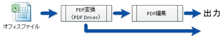
PDF 変換には Microsoft Office ソフトウェアを利用して PDF Driver で変換（出力）を行います。この処理は PDF コンバーターで行うため、PDFコンバーターが起動（常駐）している必要があります。
